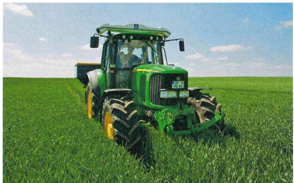
Dünger so effizient wie möglich einsetzen: N-Sensoren scannen die Bestände. Die Ergebnisse geben Aufschluss darüber, wie der Bestand die Stickstoffgabe aufnimmt.
